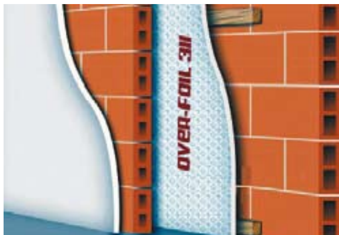
Schema di posa in parete perimetrale.
